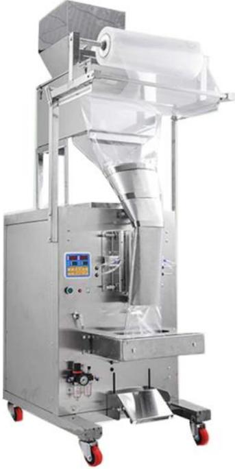
آلة تعبئة ساشيه بودرة وحببيية تعمل بالهواء المضغوط بثلاثة خيوط غلق، طراز R
